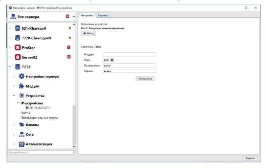
9. Если SADP при активации устройства выдает **ошибку** - нужно вручную прописать в ПК ИП адрес такой же как камера+1 и зайти через браузер по ИП камеры. Будет предложено ввести дважды пароль- вводим-ОК если пароли правильно ввели то устройство успешно активировано.
