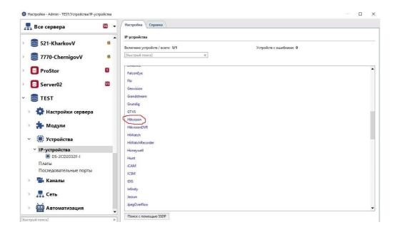
Выбираем нужную модель камеры и прописываем ИП адрес, логин пароль камеры.
