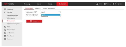
5. Переходим на вкладку Служба безопасности. Там убираем галочку с Включение блокировки нелегального входа. Сохраняем изменения.
