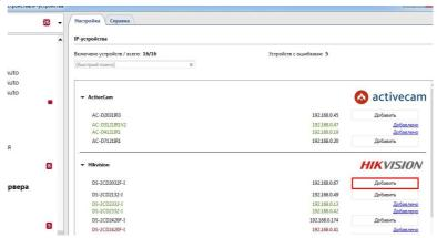
В случаях, где на объекте сложная и заблокированная сеть, автопоиск Trassir может не находить камеры. В этом случае в IP-устройства выбираем внизу пункт, Добавить вручную, выбираем камера Hikvision.
